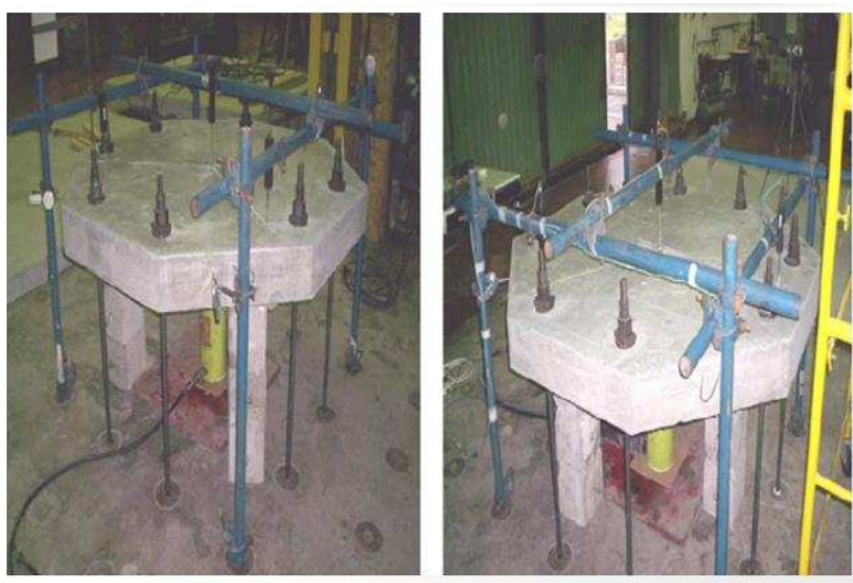
Figura 9. Montaje del ensayo experimental de los modelos LT1, LT2 y LT3 [16].
