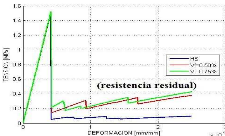
Figura 15. Rama en tracción de las curvas tensión – deformación obtenidas.
