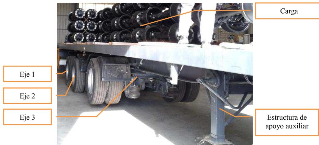
Figura 5: Prototipo de semirremolque 2+1 – Foto de detalles.
