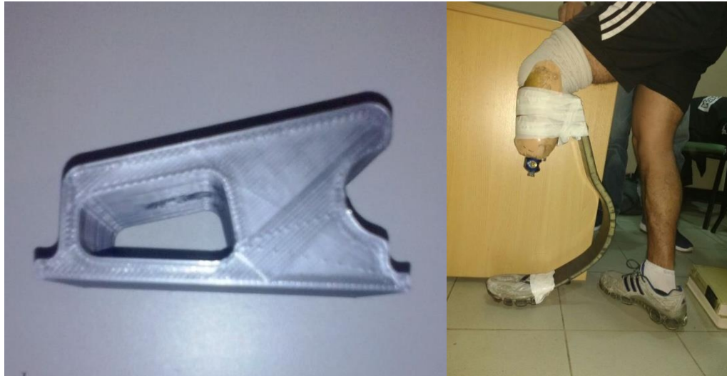
Figura 16 Impresión 3D del modelo optimizado y prueba de ángulo con el atleta (2).
