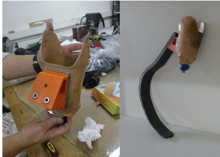
Figura 18 Pegado del anclaje y conjunto terminado
