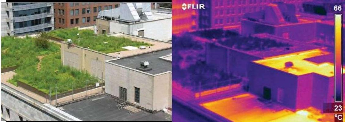
Contraste de temperaturas de una cubierta de material y una cubierta verde en imagen infrarrojo. Si se impulsaran las cubiertas verdes, arbolados y jardines verticales en las construcciones nuevas, por ejemplo con algún tipo de premio o exención de impuesto, podríamos empezar a apaciguar la falta de espacio absorbente y el aumento térmico que implica el crecimiento continuo de la ciudad.
