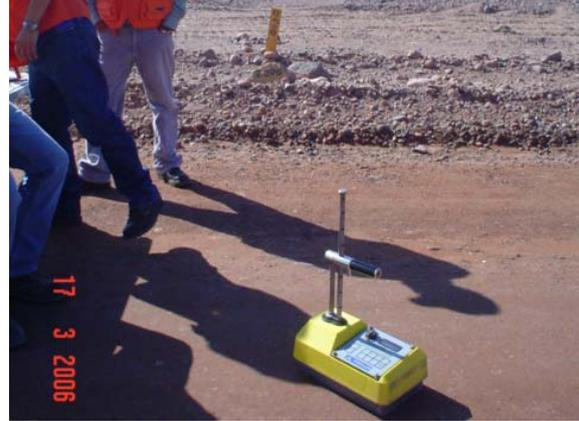
Medición in-situ de la densidad de la capa granular con densitómetro nuclear.
