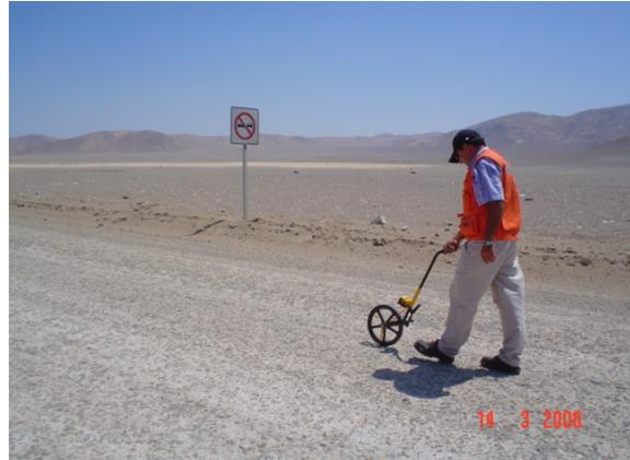
Medición con odómetro de precisión, tolerancia de  $< 0,02\%$ .
