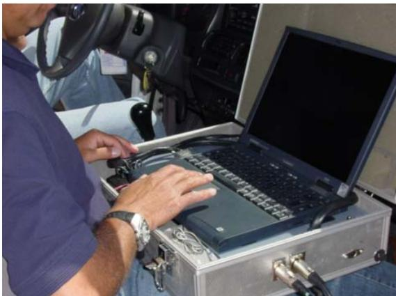
Computador conectado al acelerómetro y al odómetro del vehículo.
