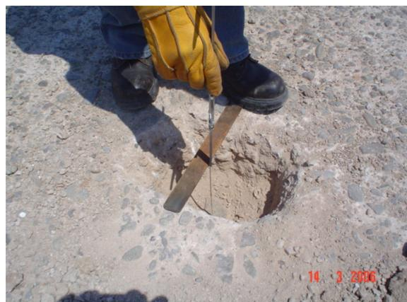
Medición de espesor remanente de las capas de rodado con piedmetro.
