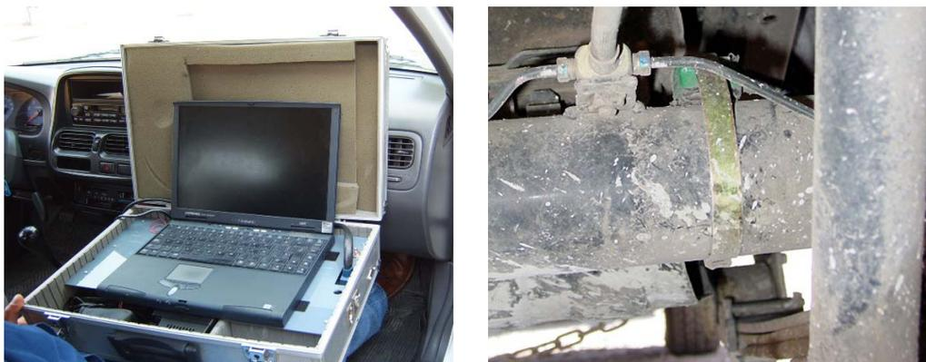
**Figura 3.9: Unidad de recolección de datos y acelerómetro**
