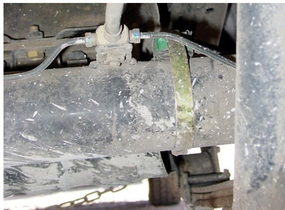
Acelerómetro instalado al eje trasero del vehículo.
