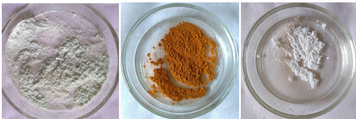
Figura III-2. Fotografías digitales de MoO_3 (izquierda), V_2O_5 (centro) y Nb_2O_5 (derecha)
