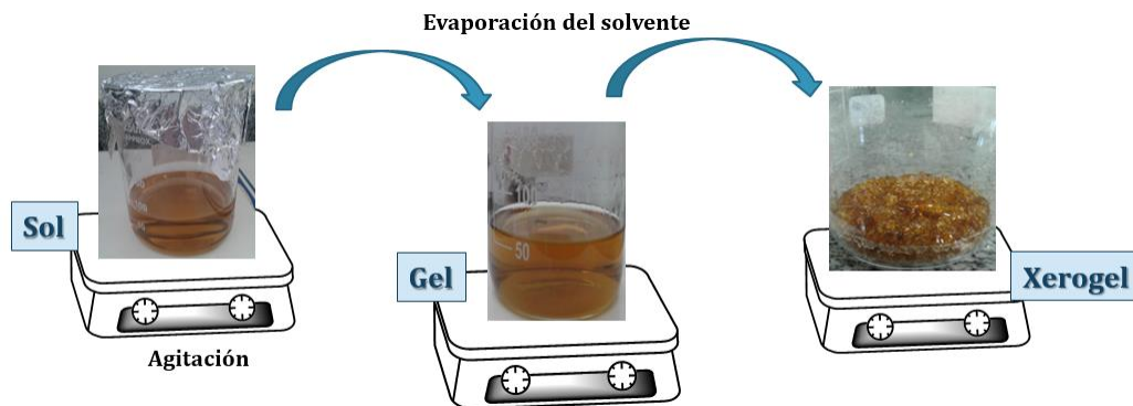
Figura I-7. Síntesis de xerogeles por el método Sol-Gel
