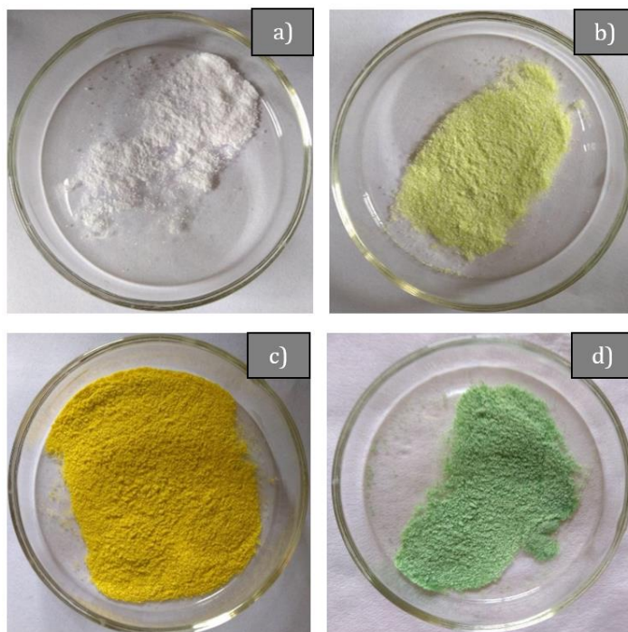
Figura III-32. Fotografías digitales los xerogeles molidos: a) \text{SiO}_2 , b) PMo-Si, c) PMoV-Si y d) PMoNb-Si
