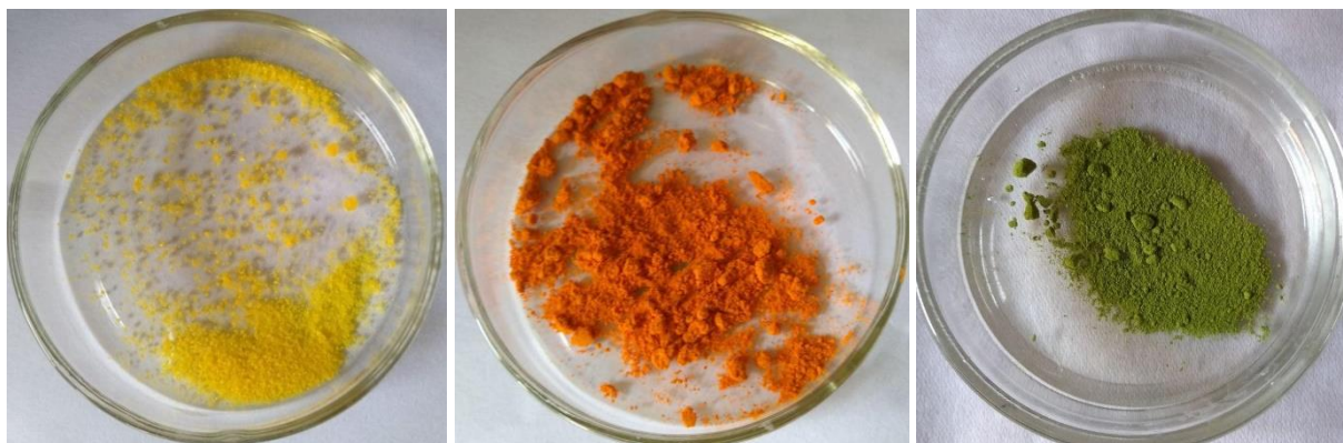
Figura III-1. Fotografías digitales de los HPAs utilizados, con su diferente coloración según el metal componente: PMo (izquierda), PMoV (centro) y PMoNb-ii (derecha)
