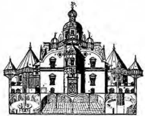
FIG. 3. — Uraniborg. "En estilo gótico renacentista, con observatorios instalados en dos torres cuyos techos en forma de pirámides podían retirarse para dar paso a los instrumentos. Debajo de los observatorios estaban el museo, la biblioteca y su laboratorio de alquimia...".
