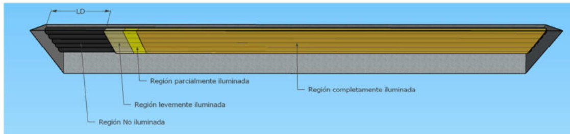
Fig. 3: Perfil de radiación solar tipo escalón sobre el absorbedor causado por los espejos a diferentes distancias focales del mismo, se esquematizan dos niveles en la región semi-iluminada.
