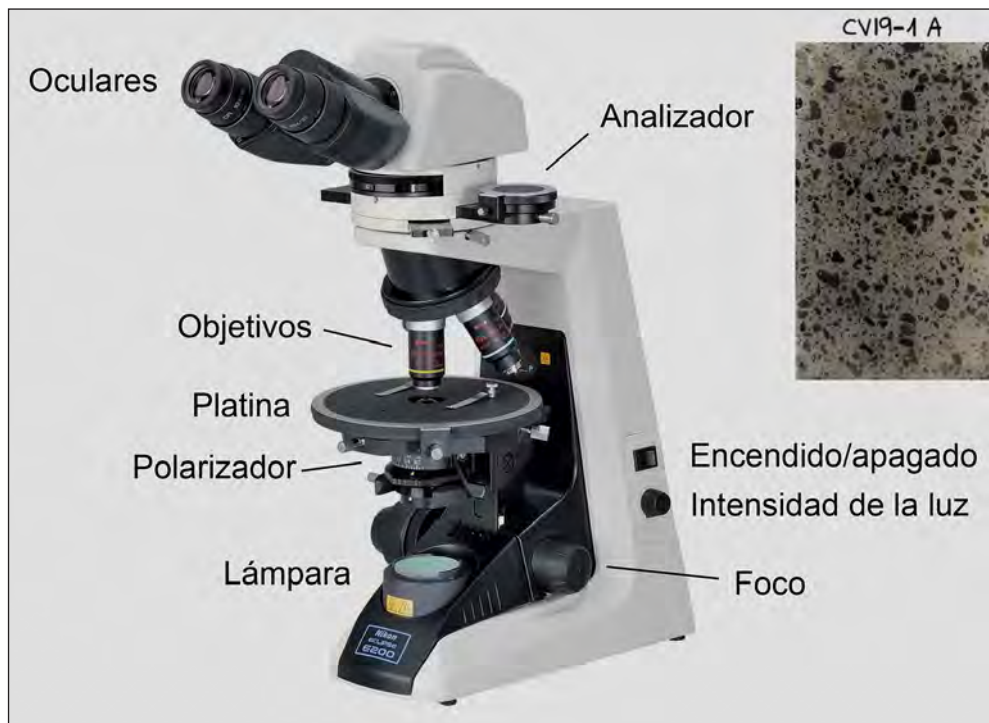
3. El microscopio petrográfico y sus partes más relevantes, junto a una foto de un corte delgado de roca (mide 4,5 cm de largo por 2,5 cm de ancho).
