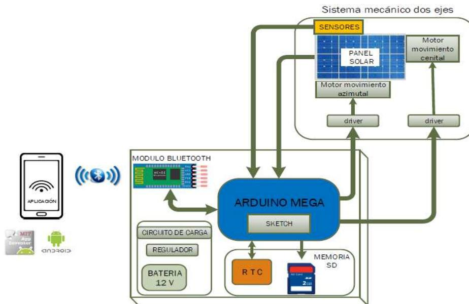
Figura 5: Bloques y dispositivos principales del seguidor solar
