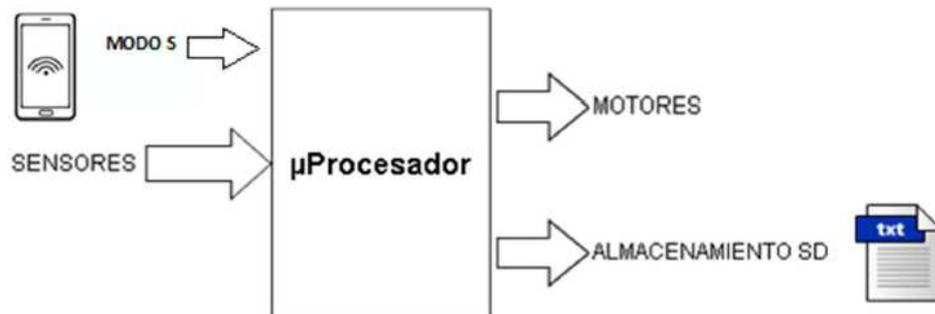
Figura 3: Diagrama del sistema modo S
