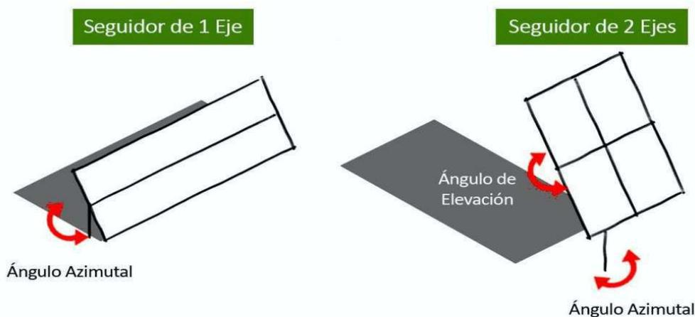
*Figura 1: Esquema de seguimiento solar.*
