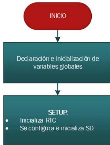
Figura 9: Diagrama de flujo de `setup()`.
