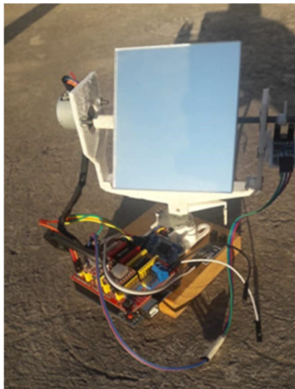
Figura 11: Fotografía del prototipo de seguidor de dos ejes.
