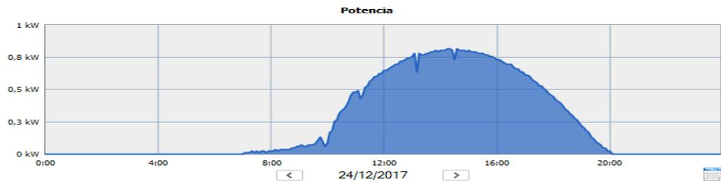
Figura 13. Grafico de generación fotovoltaica. 24 de diciembre 2017. Inversor SMA Sunny Boy.
