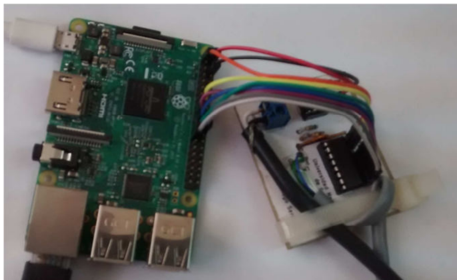
Figura 5: Interfaz desarrollada conectada a una SBC Raspberry Pi v3
