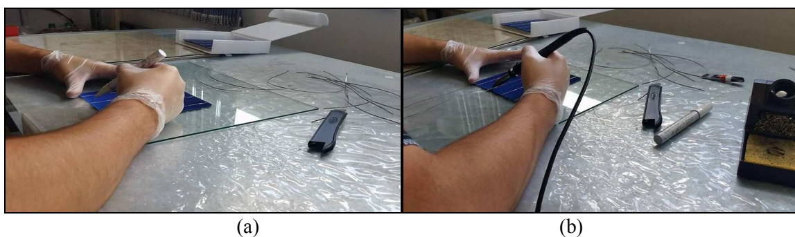
Figura 1: Fluxo de solda nos terminais da célula (a) e integração da fita de estanho (1,8 mm) na célula fotovoltaica (b).
