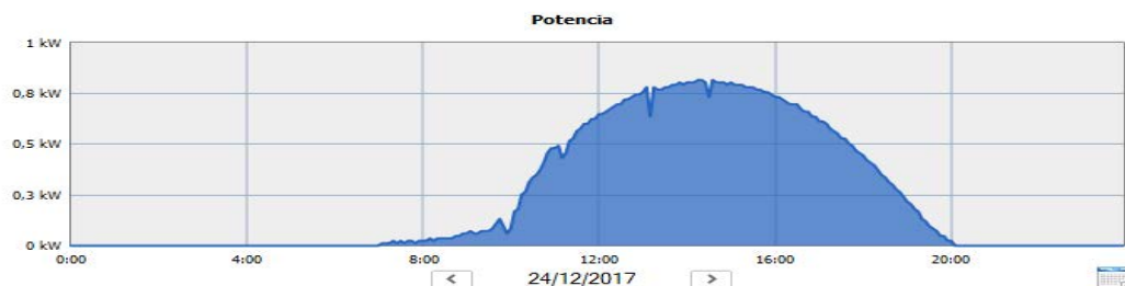
Figura 13. Grafico de generación fotovoltaica. 24 de diciembre 2017. Inversor SMA Sunny Boy.
