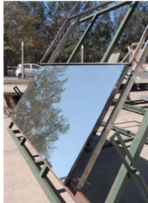
Figura 10: Fotografías de la estructura del helióstato y de una faceta.
