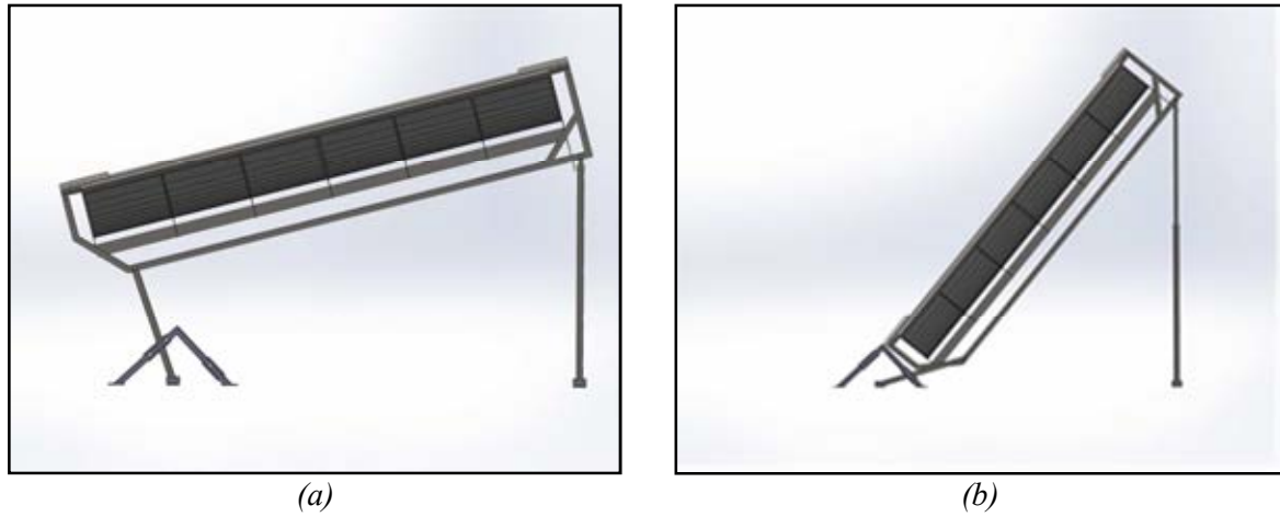
Figura 2: Posiciones extremas del CCP: (a) Diciembre (12°). (b) Julio (51°)
