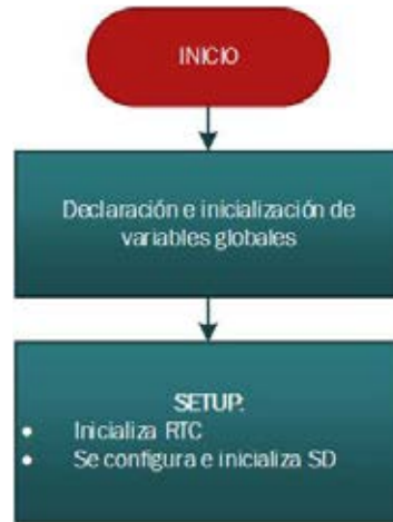
Figura 9: Diagrama de flujo de setup() .
