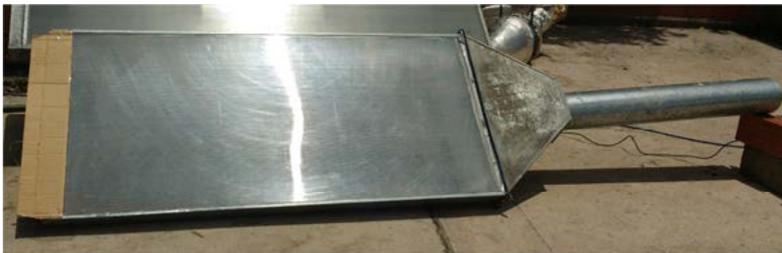
Figura 5: Fotografía del colector solar ensayado a circuito abierto.
