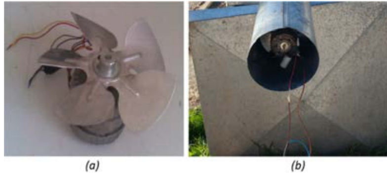
Figura 3. (a) Vista del ventilador axial utilizado, (b) Ventilador instalado en el ducto de salida.
