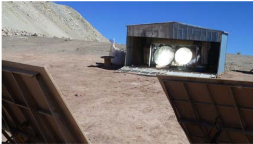
Figura 1: Primer prototipo de horno solar en la Puna salteña. Espejos planos reflejando la radiación solar sobre concentradores secundarios de disco parabólico.
