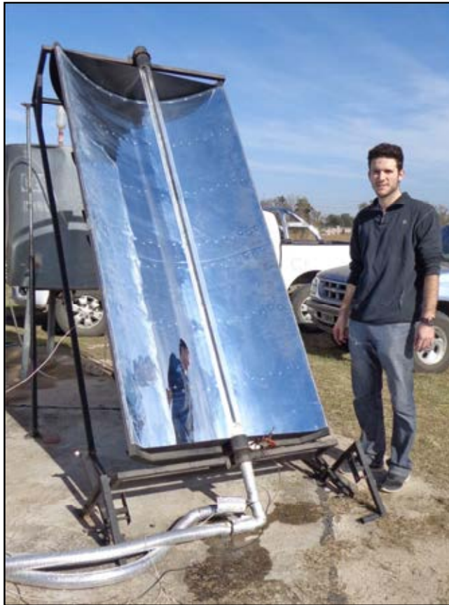
Figura 3: CCP instalado sobre la plataforma en posición invernal
