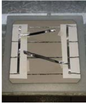
Figura 2: Estrutura da célula de referência.
