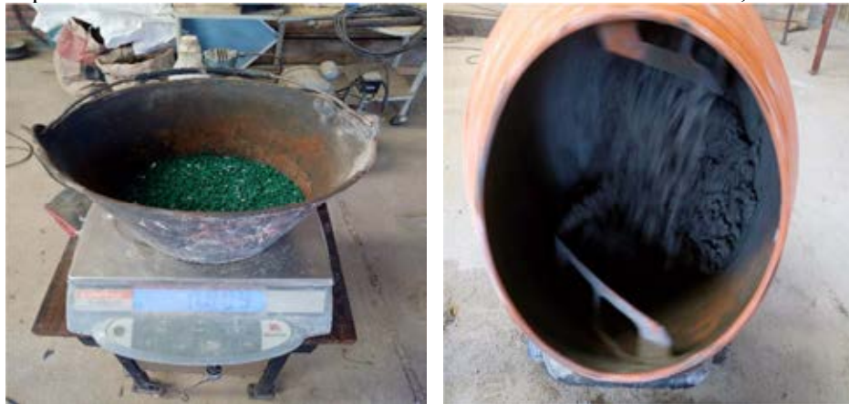
Figura 5; balanza utilizada para las dosificaciones y a la derecha la hormigonera.
