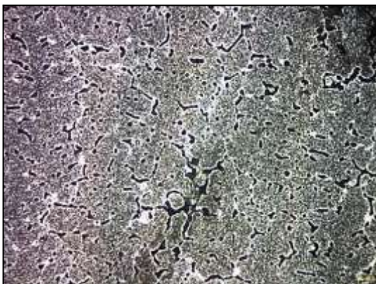
Figura 10: Material con recocido de ablandamiento modificado con ataque Graff Reagent y Keller. Aumento: 200x.
