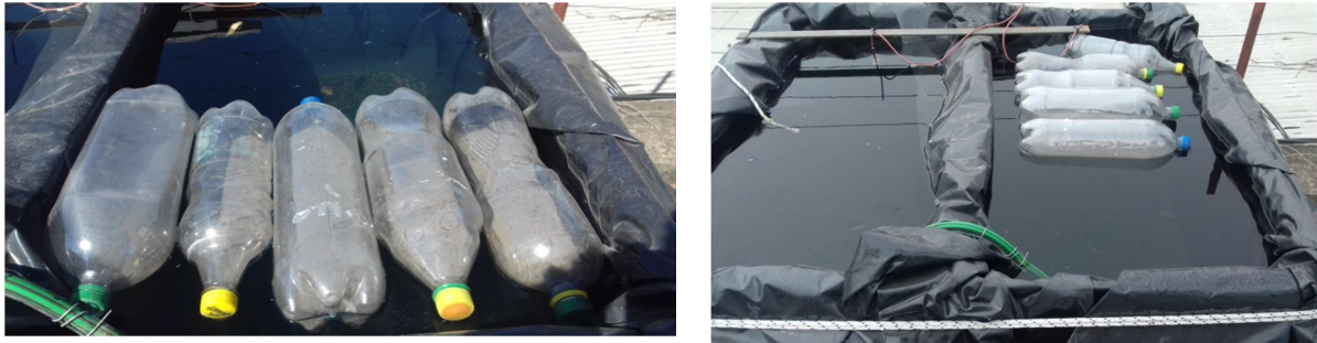
Figura 3: Vistas del ensayo con botellas recargadas con absorbente: arena y ferrite.
