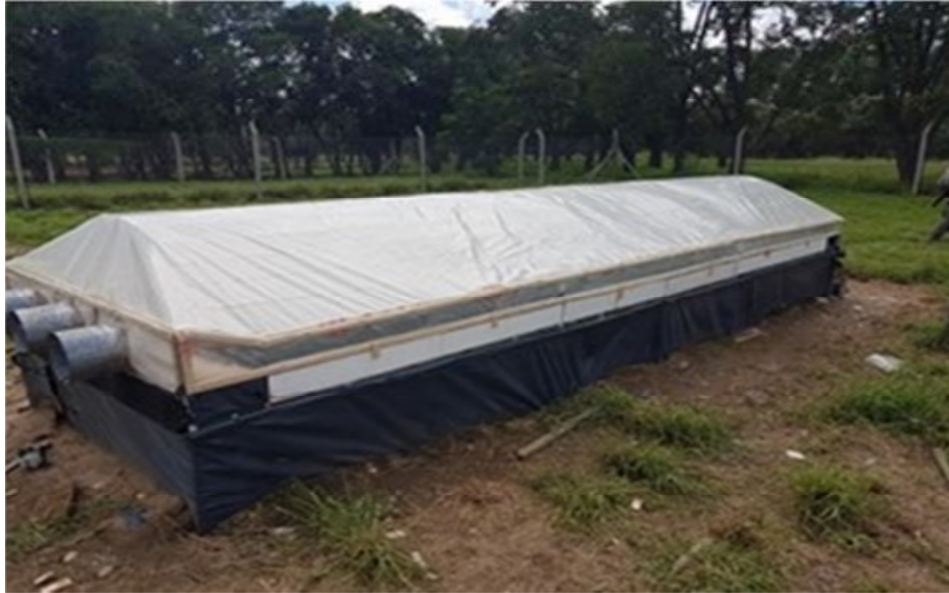
Figura 2: Vista del secadero solar compacto
