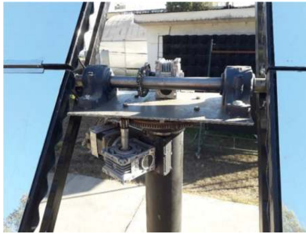
Figura 4: Mecanismo para movimiento en dos ejes
