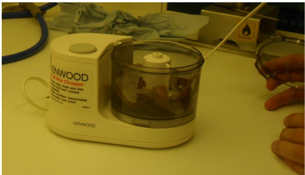
Figura 16. Procesado del micelio y el Agar Agua para la producción del slurry .
