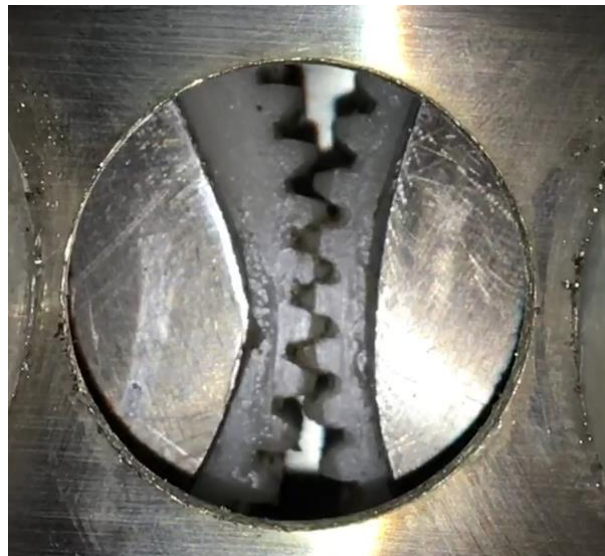
Figura 17. Engrane entre los dientes de resina acetal.
