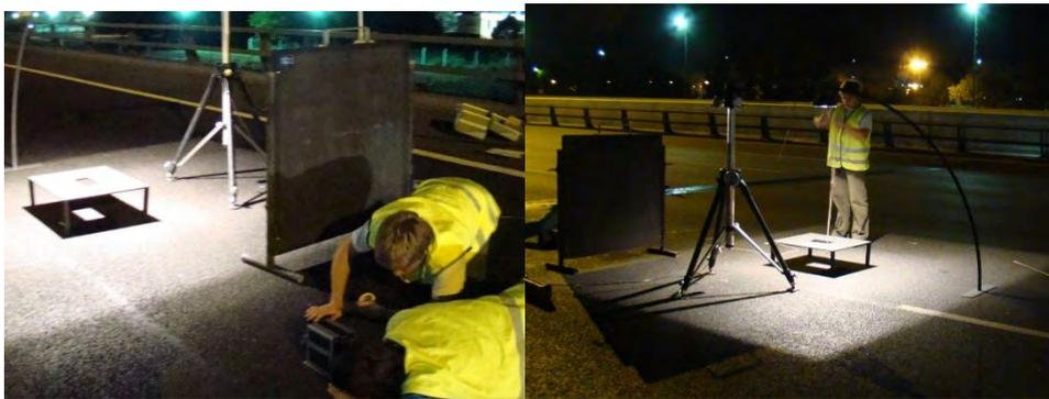
**Figura 61.** Aplicación del reflectómetro: alineación del detector (fotos del autor).
