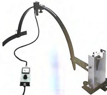
**Figura 51.** Equipo diseñado por Range para medir los coeficientes de Erbay o Burghout.<sup>18</sup>
