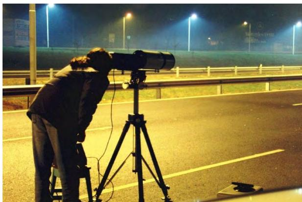
**Figura 4.** Imagen de una medición de luminancia en calzada realizada por el autor (1998, Au. del Oeste –Foto del autor-).
