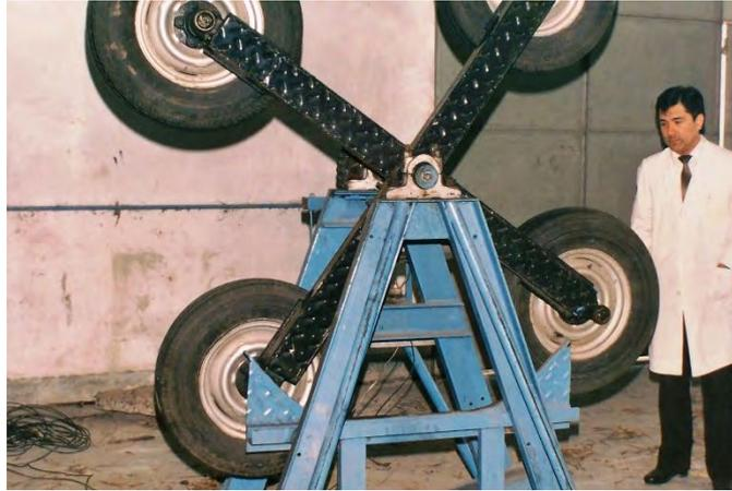
**Figura 3.** Equipo experimental para el desgaste de probetas diseñado y construido en el LAL (foto del archivo del LAL).
