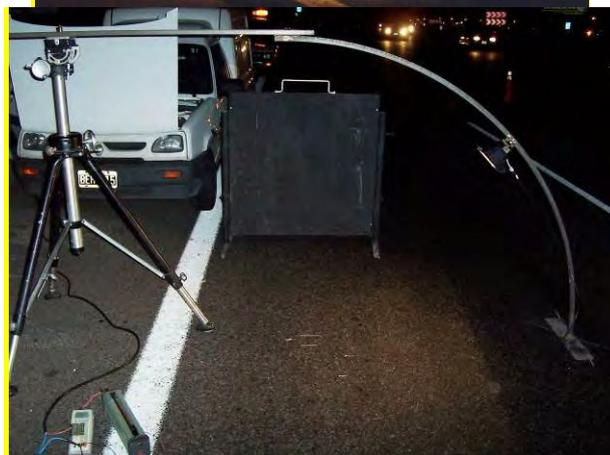
**Figura 60.** Aplicación del reflectómetro: sistema de iluminación (fotos del autor).
