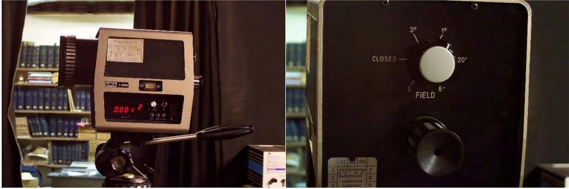
**Figura 37.** Luminancímetro. Detalle del ajuste de aperturas (Fotos del autor).
