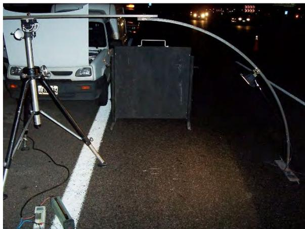
**Figura 77.** Montaje del Reflectómetro, autopista del Oeste (foto del autor).
