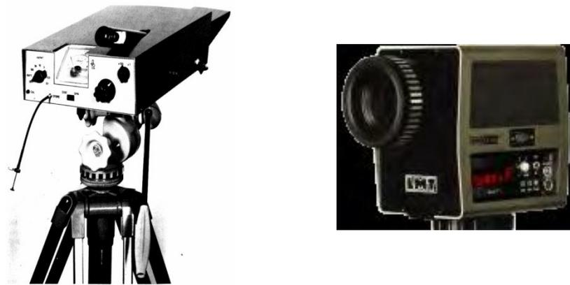
**Figura 43.** Luminancímetros utilizados en mediciones de luminancia en rutas. Instrumento analógico empleado en los `80.<sup>23</sup> Instrumento digital usado en el LAL.<sup>24</sup>
