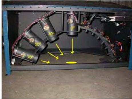
**Figura 54.** Prototipo de medidor compacto desarrollado por Laurent.<sup>7</sup>
