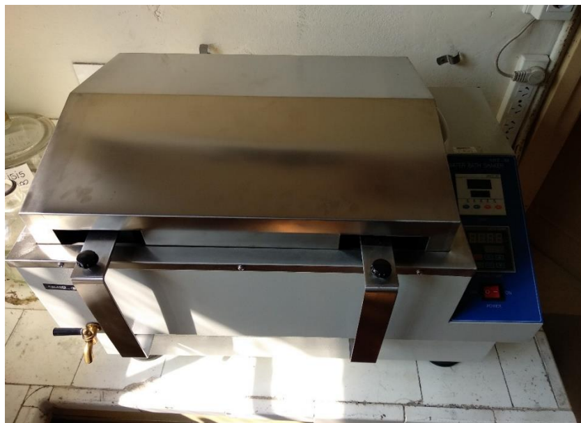
Figura 2.8: Equipo termostatzador utilizado para los experimentos en discontinuo.
