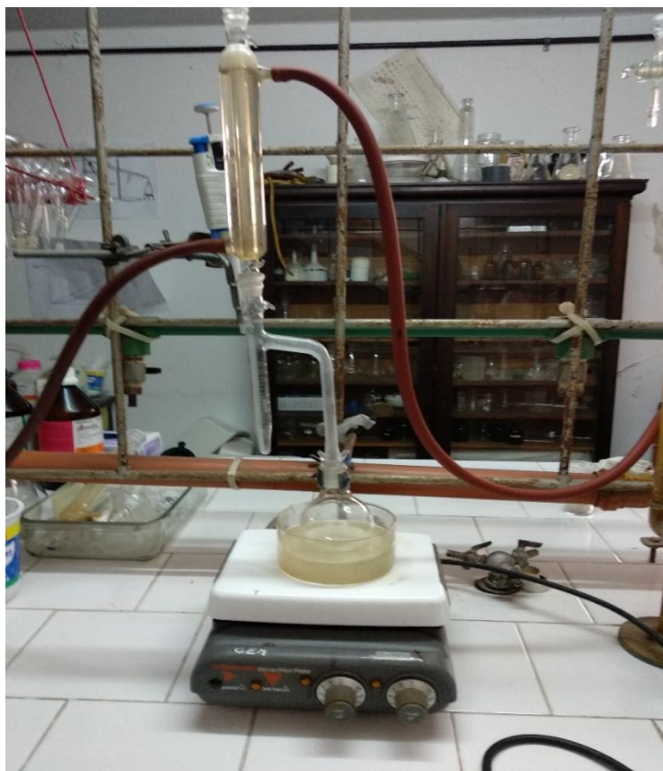
Figura 2.2: Equipo utilizado en la derivatización de la sílice.
