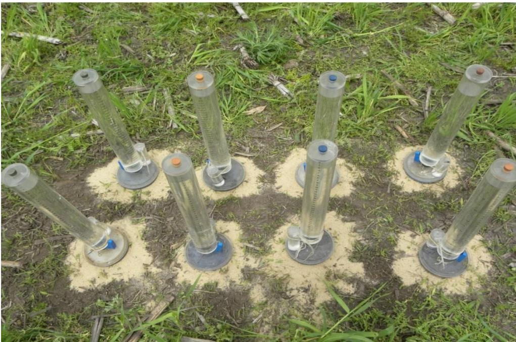
Fotografía 2. Ensayos de infiltración a campo.
