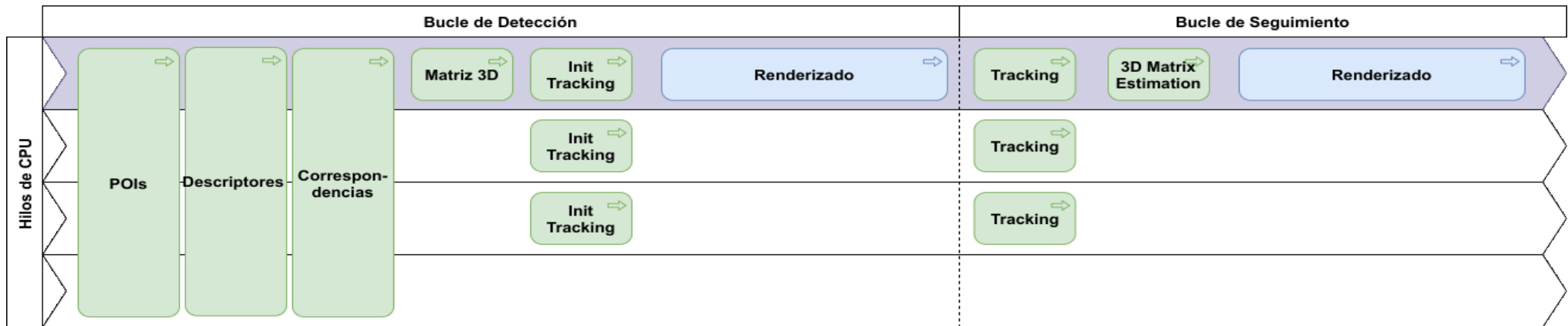
Figura 4.5. Distribución de la ejecución de algoritmos del subproceso de imágenes sobre distintos hilos de CPU. El andarivel resaltado representa el hilo de ejecución principal de la aplicación.
