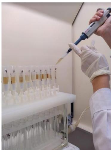
**Fig. 6.** Elución de los hidrolizados de pared celular por columnas Strata NH<sub>2</sub> 500 mg/3 mL (Phenomenex, Estados Unidos) en sistema de vacío.
