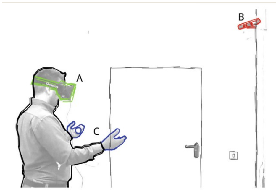
Figura 3. 13. Configuración para el experimento. (A). El entorno de entrenamiento virtual se muestra utilizando un Oculus Rift . (B). El usuario es seguido por la Microsoft Kinect . (C). La apertura y el cierre de las manos se detectan con guantes. Fuente: Tomado de Stephanidis (2015)
