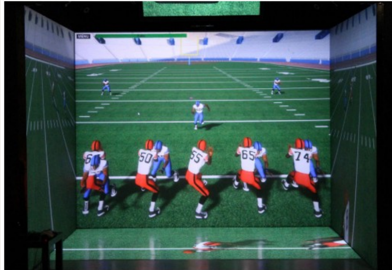
Figura 3. 17. SIDEKIQ se ejecuta en la plataforma CAVE de 4 paredes EON I Cube para sesiones de entrenamiento inmersivo. Fuente: Tomado de Huang, Churches, & Reilly, (2015)
