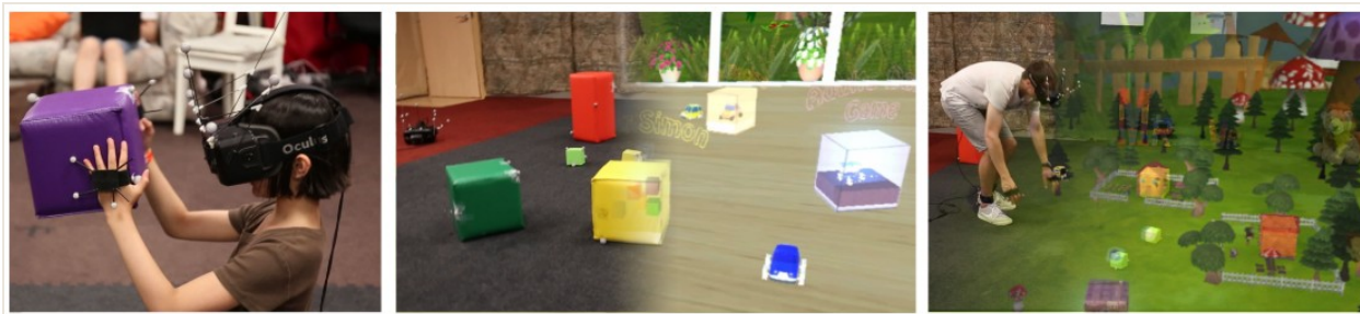
Figura 3. 25. TactileVR : sistema que permite a los usuarios moverse e interactuar libremente con objetos físicos y juguetes, que coexisten en un mundo virtual, una presencia inmersiva y retroalimentación táctil en la realidad virtual. Fuente: Tomado de Shapira, Amores, & Benavides (2016).
