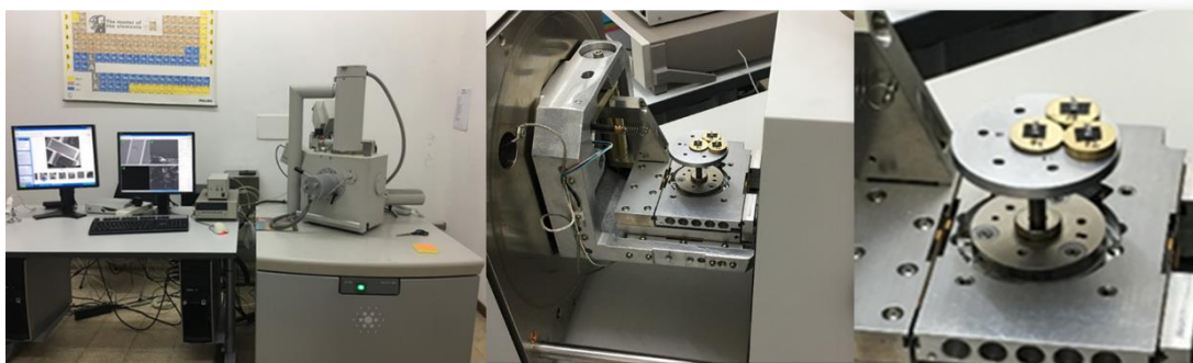
Figura 36. Laboratorio de Microscopía Electrónica de Barrido del LIMF. Microscopio electrónico de barrido ambiental ESEM (Environmental Scanning Electron Microscopy). Modelo: FEI ESEM Quanta 200. La capacidad analítica el equipo consta de un analizador dispersivo en energías EDS (Energy Dispersive Spectrometer). Servicio de microscopía electrónica de barrido y microanálisis LIMF. Departamento de Materiales de la Facultad de Ingeniería de la Universidad Nacional de La Plata.
