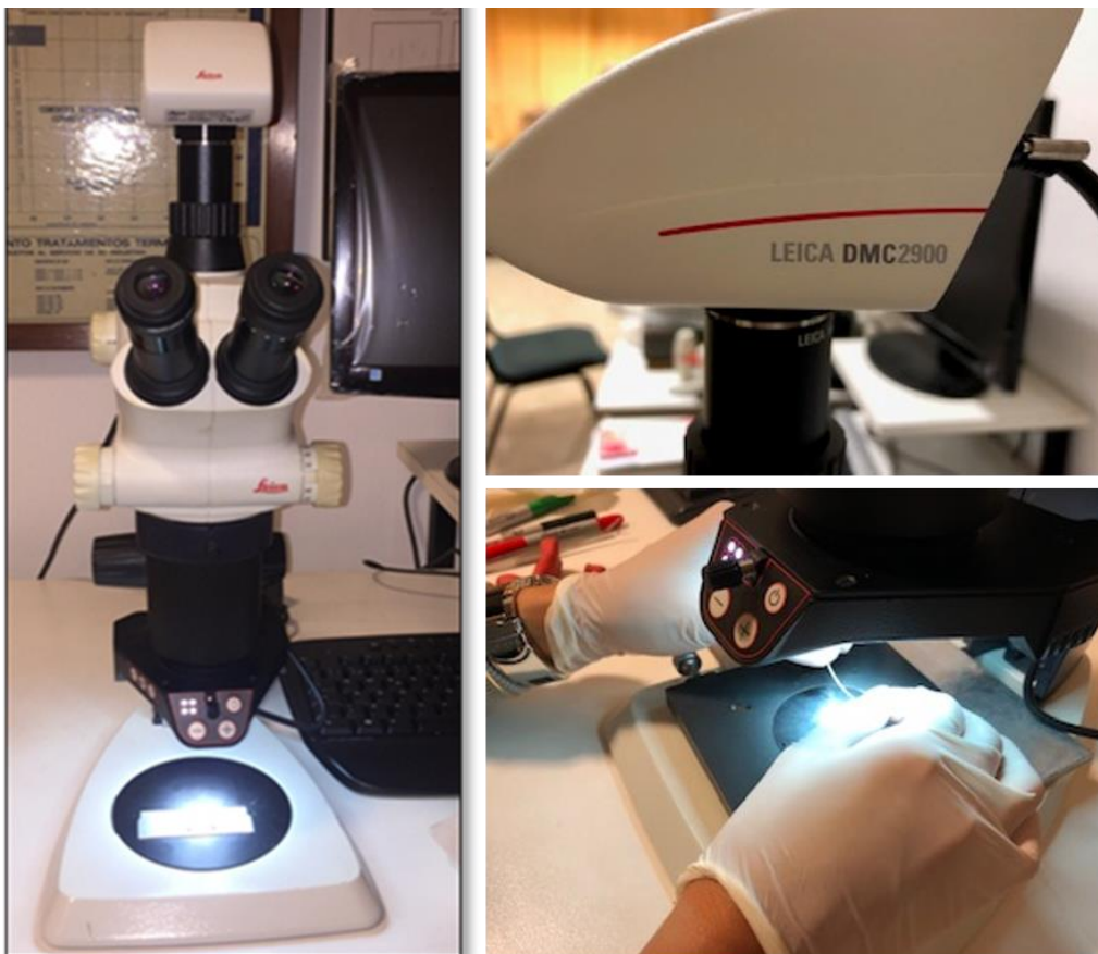
Figura 40. Lupa Leica DMC 2900, donde se puede ver el modo en que se realizó.
