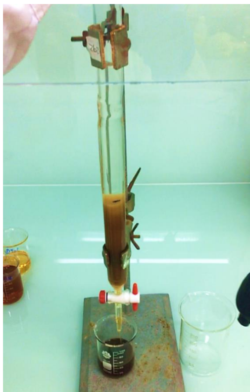
Figura 5. Foto de la separación de maltenos mediante cromatografía en columna.
