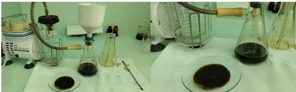
Figura 3. Fotos del equipo de filtración en vacío para separar asfaltenos de maltenos.
