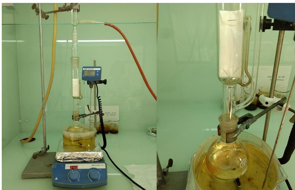
Figura 4. Fotos del equipo de extracción Soxhlet para separar asfaltenos de resinas tipo I.
