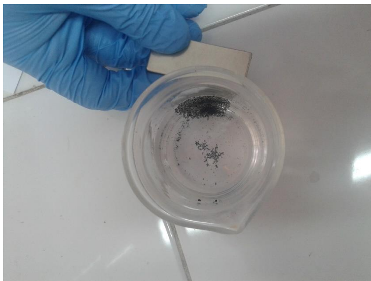
Figura 5.8 Fotografía del material CM750 frente a la aplicación de un imán de neodimio en medio acuoso.
