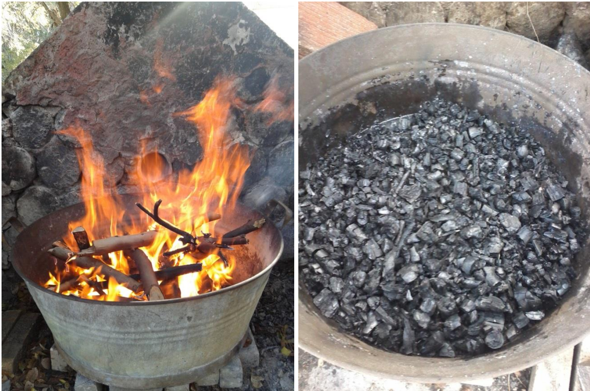
Figura 4.3 Imágenes del proceso de carbonización y del producto resultante de uno de los batches .
