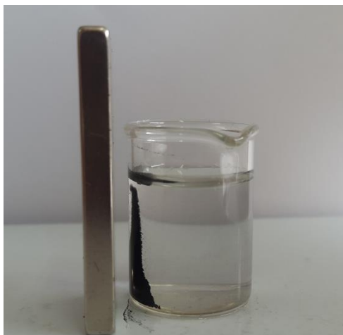
Figura 6.7. Fotografía del material CVII frente a la aplicación de un imán de neodimio en medio acuoso.
