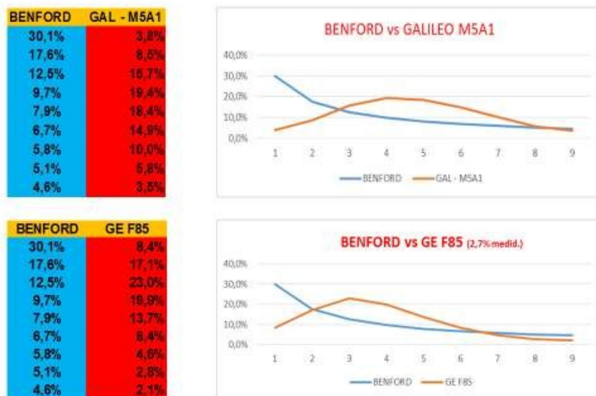
Gráfico 1 – Ejemplo de dos grupos de medidores muy distantes a la distribución de Benford
