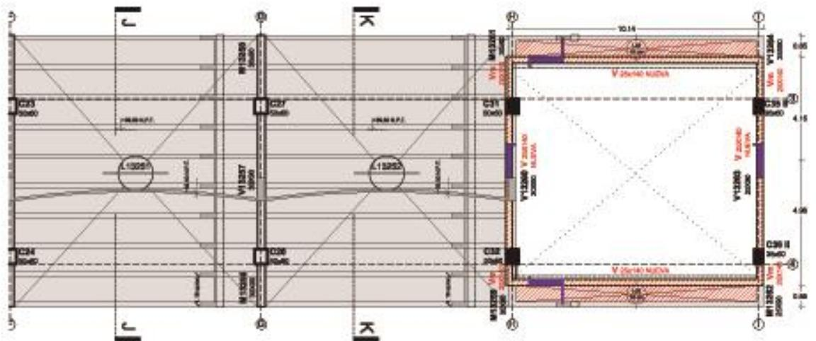
DETALLE CONDICIÓN LUEGO DE LA DEMOLICIÓN SECTOR SET DE TV – LOSA SOBRE PLANTA OCTAVA
