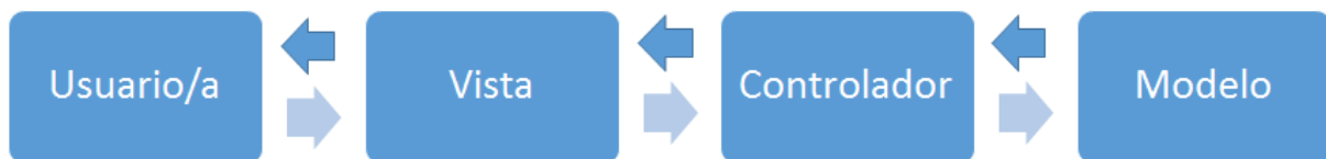
Diagrama 5: Arquitectura Modelo - Vista - Controlador (MVC)
