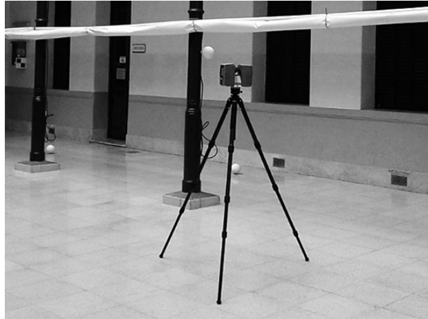
Figura 5. Fotografía del TLS Trimble TX5 durante el relevamiento del patio interior.
