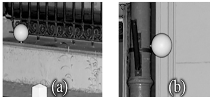
Figura 9. (a) Esfera con ubicación apropiada para referenciar mediante mediciones con estación total. (b) Esfera que no posee una ubicación apta para colocar el miniprisma
