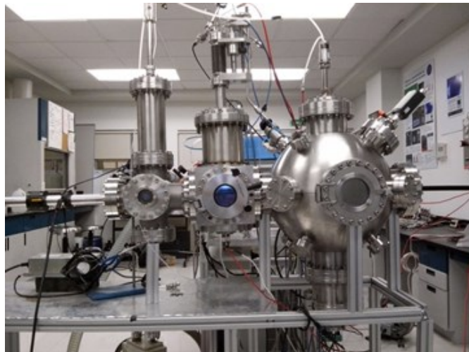
Figura 3.11: Equipo utilizado para el crecimiento de las capas delgadas de ZnO.
