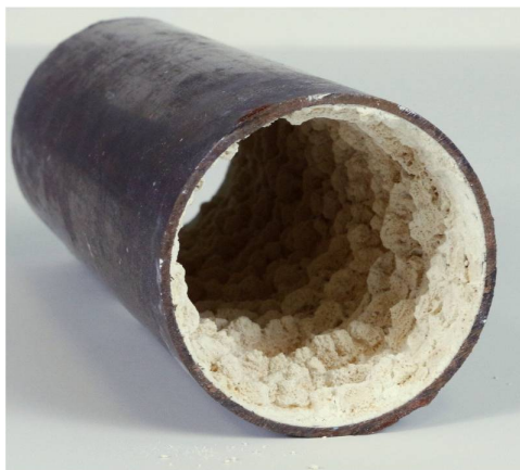
Fig. 2. Incrustación de calcio en cañería.
