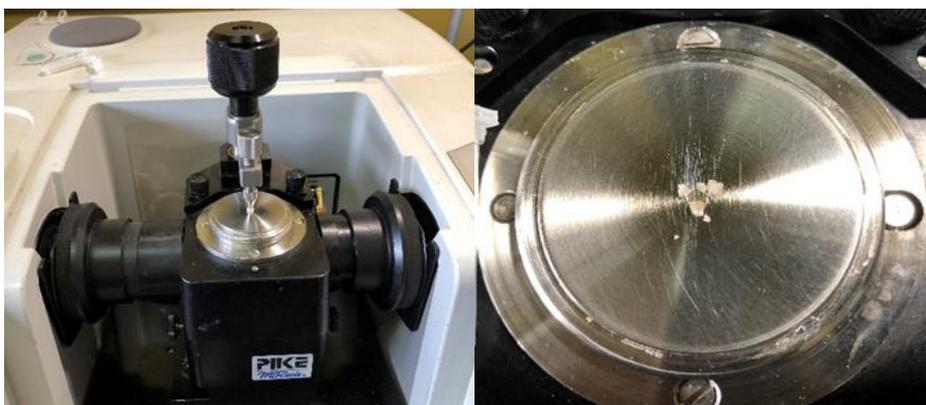
**Fig. 5.3** Accesorio ATR monoreflexión PIKE empleado en la obtención de los espectros ATR-FTIR con una muestra aplicada (izquierda) y plataforma con cristal de ZnSe luego de procesar la muestra (derecha).
