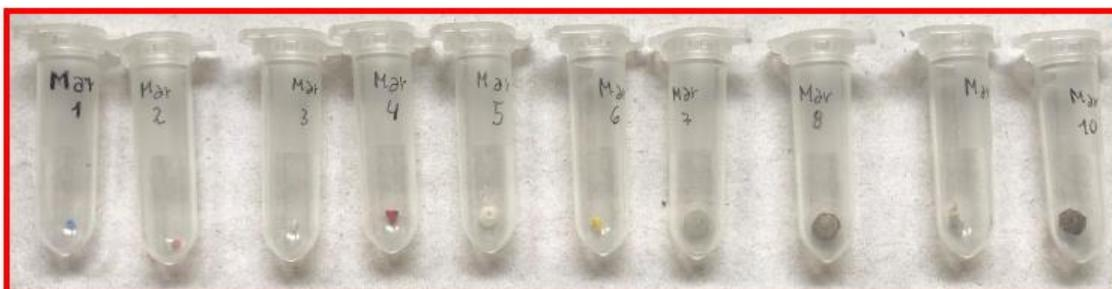
**Fig. 5.2** Submuestra de 10 MPs del mes de marzo, seleccionados para su análisis mediante FTIR.
