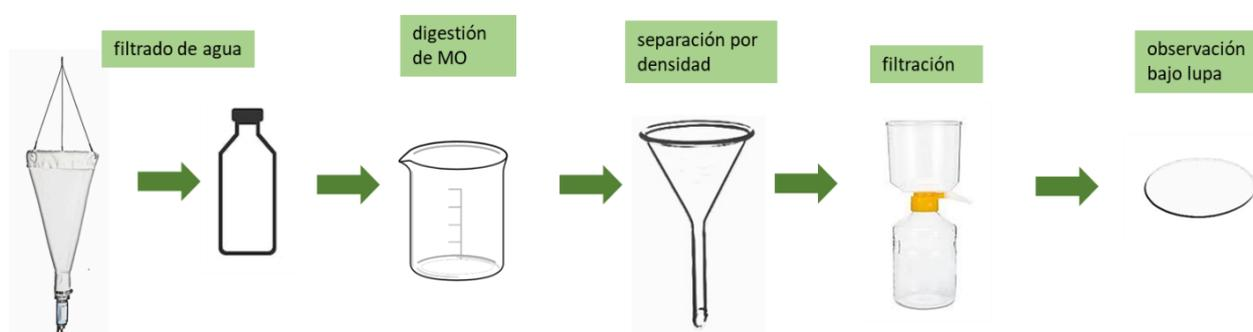
La separación por densidad es una de las técnicas más confiable y más comúnmente utilizada para la separación de MPs en muestras de agua y sedimento, ya que dependiendo de la densidad de la solución empleada, los MPs flotarán en la superficie y las
