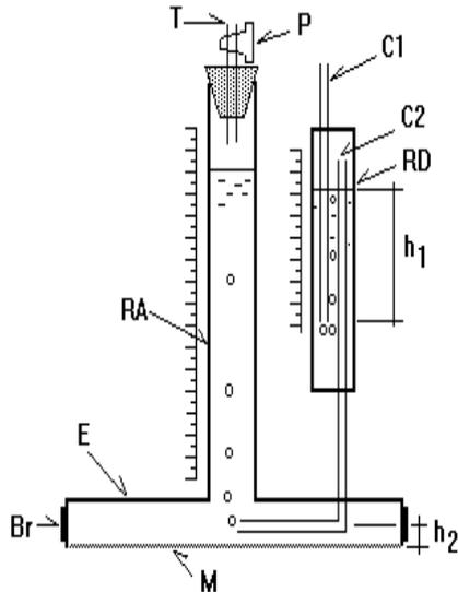
Figura 1. Esquema del permeámetro de disco
