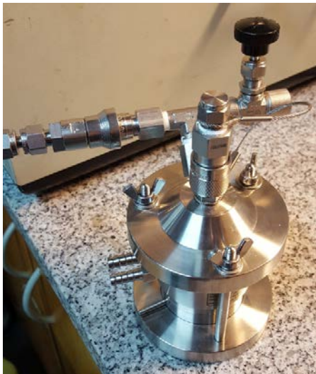
Ilustración 21 Lipex extruder Transferra Nanosciences Inc 8855 northbrookcourt 10 ml extruder Modelo MAOP Psig 850; bar 58,6; Maot (°C) 80; Min Vol Extrusión 1ml
