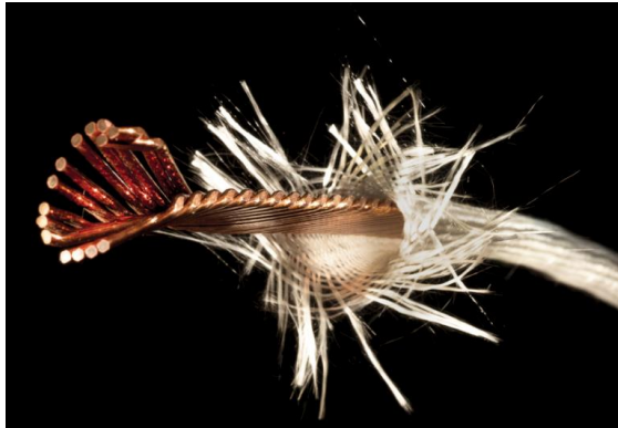
Figura 2.26. Cables de Nb 3 Sn que muestra el aislamiento de fibra de vidrio parcialmente desenvuelto. Tomado de CERN (CERN Courier, 2020)
