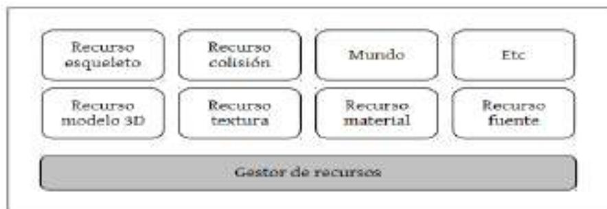
Figura 4.2: Visión conceptual del gestor de recursos y sus entidades asociadas. Esquema adaptado de la arquitectura propuesta en [40].
