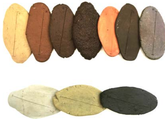
Pruebas sin cuarzo a 1180°C
