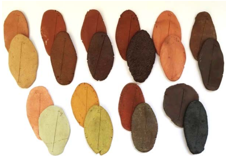
Comparativa de las mismas fórmulas horneadas a distintas temperaturas
