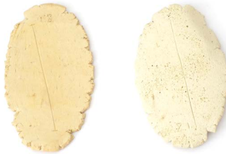
Izquierda. Prueba 8 con cuarzo horneada a 1180°C Derecha. Prueba 8 con cuarzo, horneada a 1060°C
