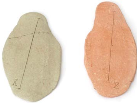
Izquierda. Prueba 8 sin cuarzo, horneada a 1180°C Derecha. Prueba 8 sin cuarzo, horneada a 1060°C
