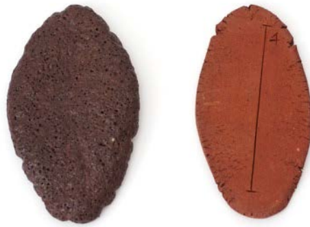
Izquierda. Prueba 4 sin cuarzo, horneada a 1180°C Derecha. Prueba 4 sin cuarzo, horneada a 1060°C
