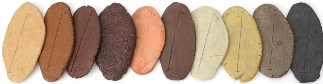
Muestras Sin cuarzo a 1180 a C, en orden numérico ascendente
