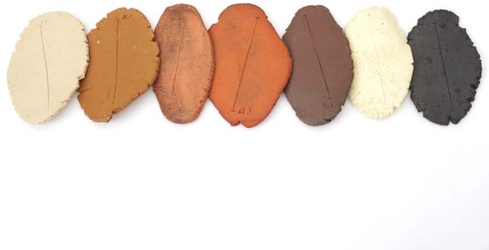
Pruebas con cuarzo y modificaciones de óxidos a 1180°C
