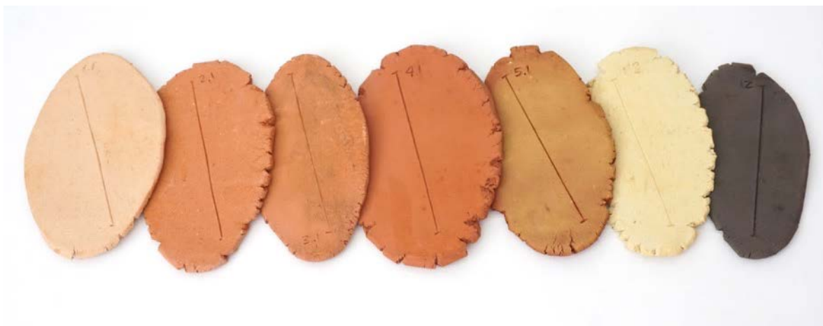
Muestras modificadas con cuarzo a 1060°C.
