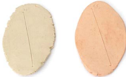
Izquierda. Prueba 1 con cuarzo, horneada a 1180°C Derecha. Prueba 1 con cuarzo, horneada a 1060°C
