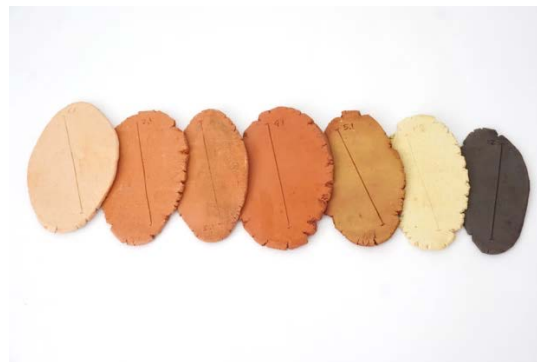
Pruebas con cuarzo y modificaciones de óxidos a 1060°C
