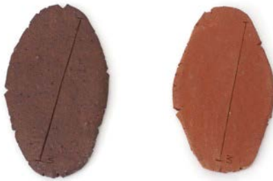
Izquierda. Prueba 3 sin cuarzo, horneada a 1180°C Derecha. Prueba 3 sin cuarzo, horneada a 1060°C
