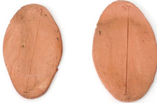
Izquierda. Prueba 5 sin cuarzo, horneada a 1180°C Derecha. Prueba 5 sin cuarzo, horneada a 1060°C
