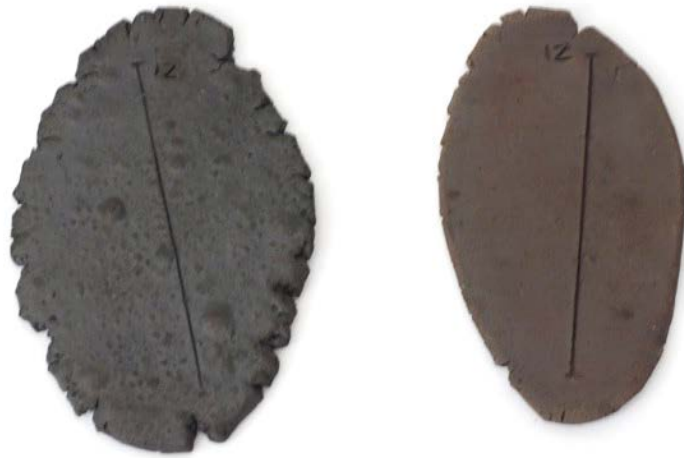
Izquierda. Muestra 12 horneada con cuarzo a 1180°C Derecha. Muestra 12 horneada con cuarzo a 1060°C
