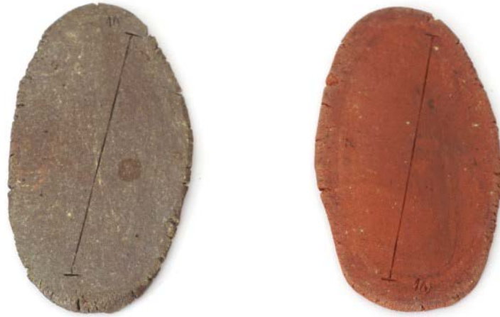
Izquierda. Prueba 10 sin cuarzo, horneada a 1180°C Derecha. Prueba 10 sin cuarzo, horneada a 1060°C
