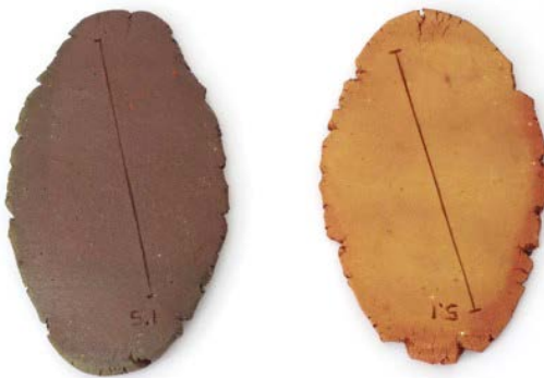
Izquierda. Prueba 5 con cuarzo, horneada a 1180°C Derecha. Prueba 5 con cuarzo, horneada a 1060°C
