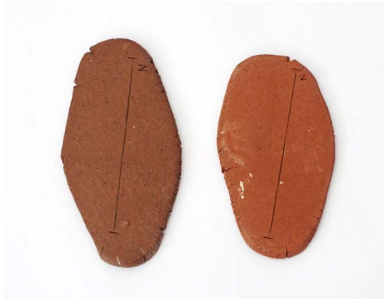
Izquierda. Prueba 2 sin cuarzo, horneada a 1180°C Derecha. Prueba 2 sin cuarzo, horneada a 1060°C
