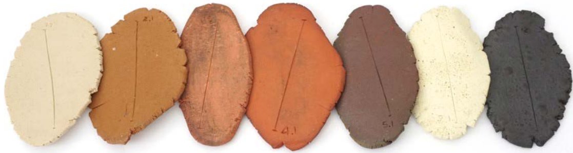
Muestras modificadas con cuarzo a 1180°C
