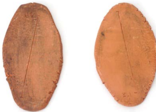
Izquierda. Prueba 3 con cuarzo, horneada a 1180°C Derecha. Prueba 3 con cuarzo, horneada a 1060°C
