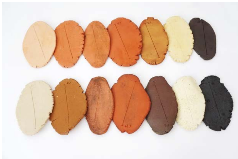
Comparativa de las mismas fórmulas con cuarzo y modificaciones de óxidos horneadas a distintas temperaturas
