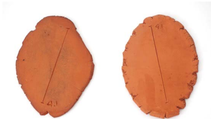
Izquierda. Prueba 4 con cuarzo, horneada a 1180°C Derecha. Prueba 4 con cuarzo, horneada a 1060°C
