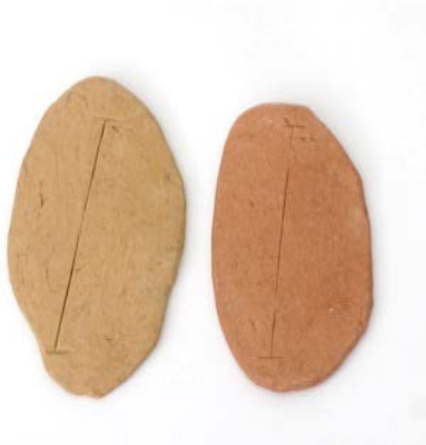
Izquierda. Prueba 1 sin cuarzo, horneada a 1180°C Derecha. Prueba 1 sin cuarzo, horneada a 1060°C
