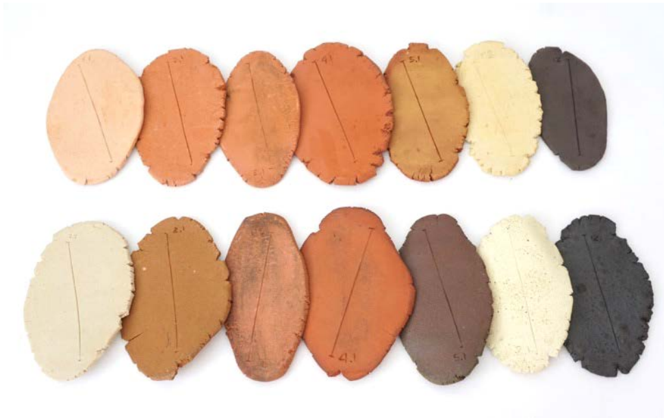
Comparativa de las paletas (arriba) horneadas a 1060°C y (abajo) horneadas a 1180°C en orden ascendente de fórmula.
