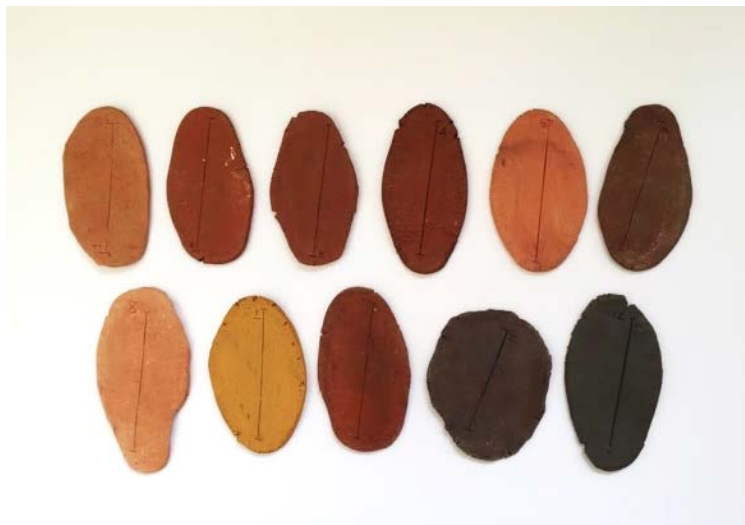
Pruebas sin cuarzo a 1060°C
