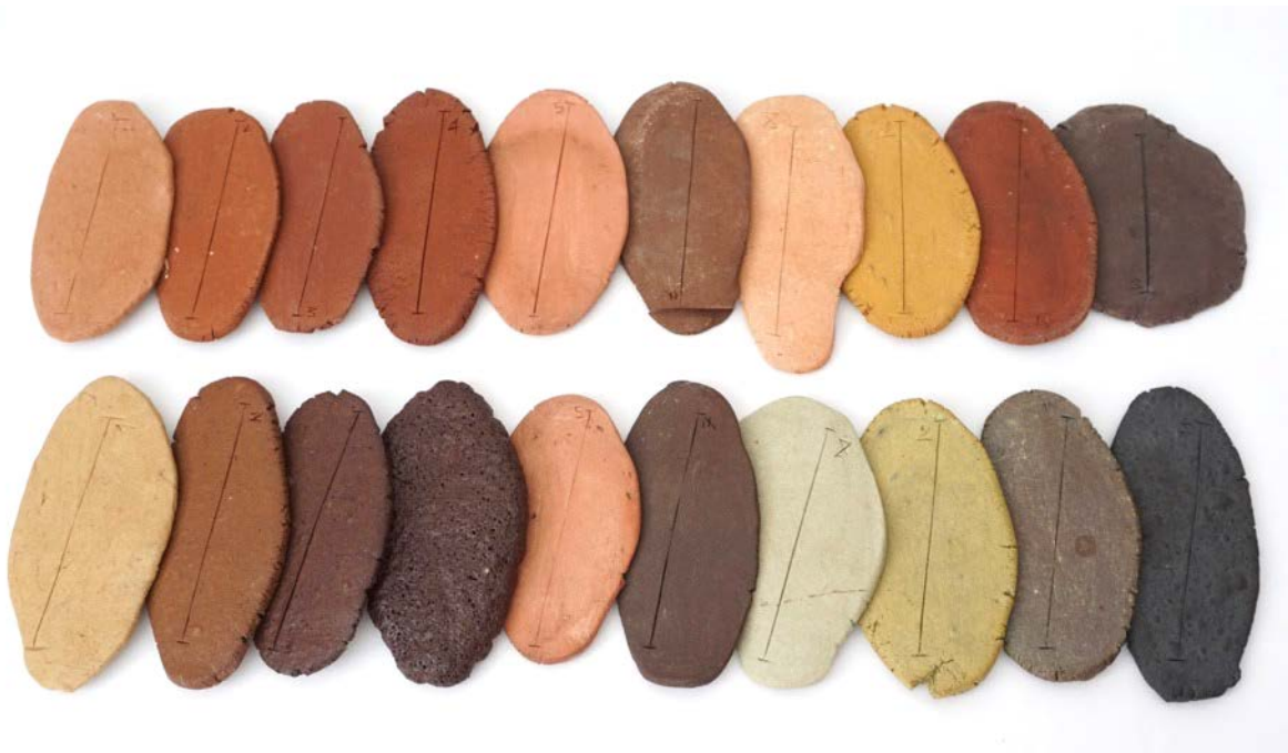
Comparativa de las paletas (arriba) horneadas a 1060°C y (abajo) horneadas a 1180°C en orden ascendente de fórmula
