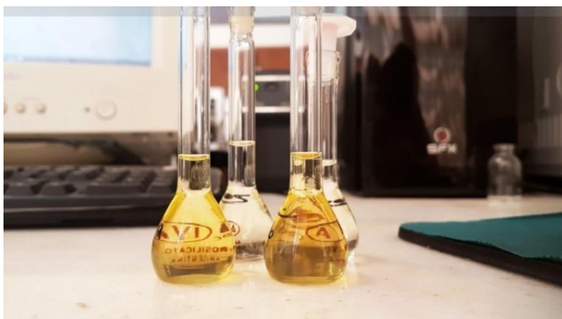
Figura 11 – Extractos de Cannabis no tipificado obtenidos a partir de la extracción con gas propano.
