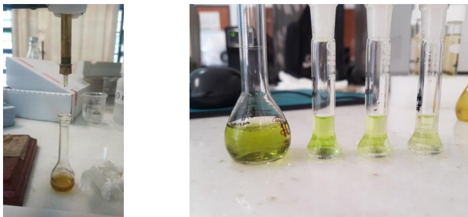
Figura 13 - Extracción de Cannabis con solvente mediante columna de extracción. A la izquierda: dispositivo; a la derecha: extractos obtenidos.
