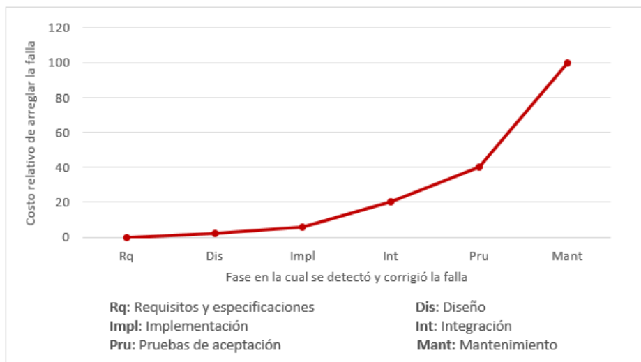
Figura 1.2. Costo relativo a la corrección de una falla en cada fase del ciclo de vida del software tradicional
