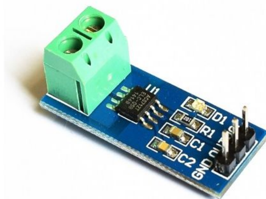
Figura 2.3: Sensor de efecto Hall ACS712 de Allegro Microsystems. Fuente: Allegro Microsystems ACS712.
