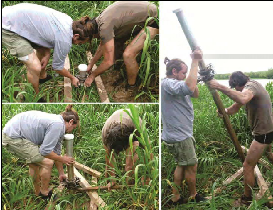
Foto 3.15. Sitio de instalación de la trampa N° 20 en el interior de un ensamble, con profundidad puntual de agua de ca. 2 m al momento de instalarla. La baja consistencia del sedimento permitió hacer un sondeo por simple hincado de un tubo, complementado en parte con percusión.
