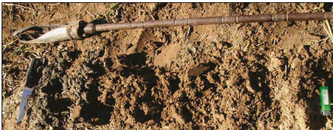
Foto C.1. Muestreo y evaluación de sedimentos superficiales de la planicie con barreno manual (área de influencia del A° Falso Toro, en el delta del A° Leyes).
