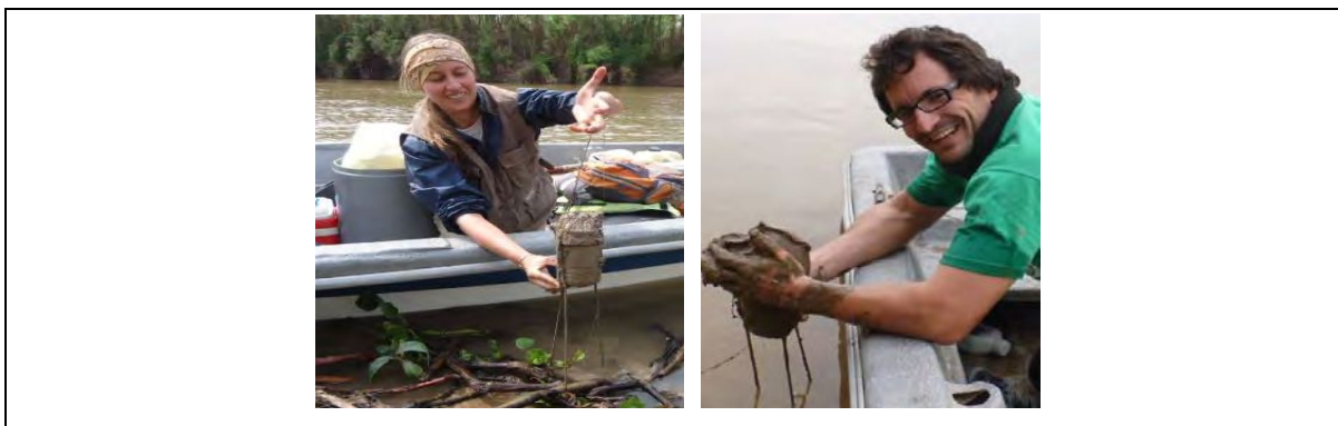
Foto 3.12. Recuperación de las trampas de sedimento (se muestra a la vez su diseño; dentro de los ensambles se las introducía por un tubo, empujadas con una vara hasta anclarlas al lecho).
