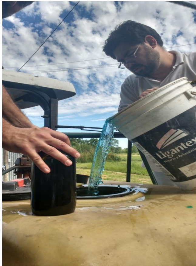
Foto 6. Incorporación al tanque de pulverización del trazador de tipo alimenticio, Azul Brillante (FD&C Azul No. 1).
