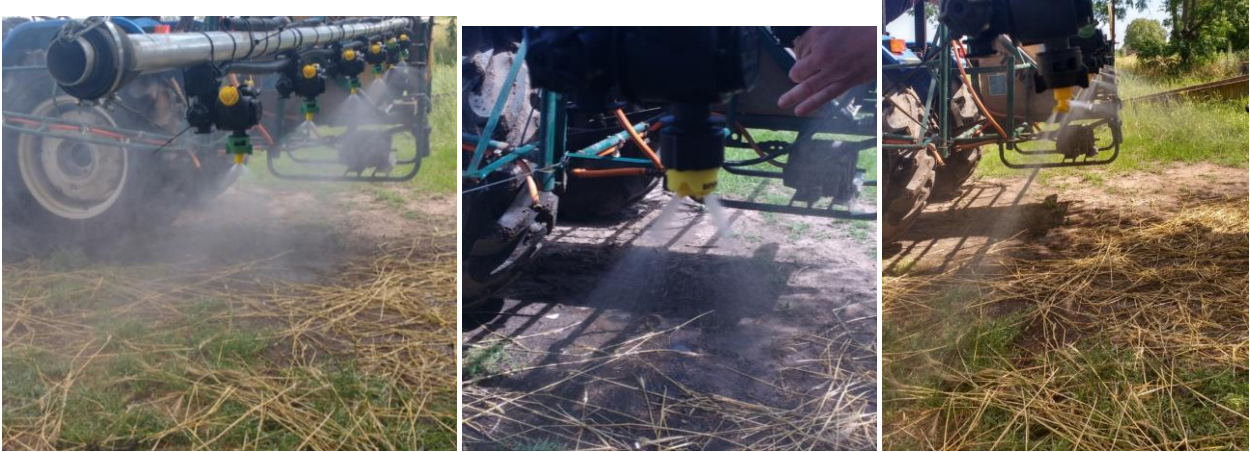
Foto 8, 9 y 10. Vista lateral de las boquillas utilizadas en el ensayo, colocadas en el portapico múltiple, de izquierda a derecha: TXA8002, AI3030 y AI3070
