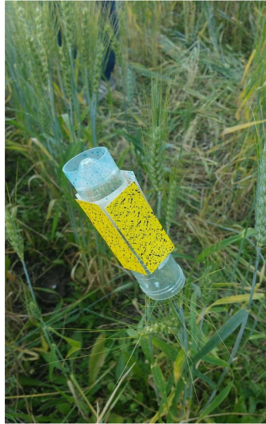
Foto 15. Tubo cilíndrico cubriendo la espiga con tarjetas hidrosensibles adosadas al mismo, previo al avance de la máquina pulverizadora. Las tarjetas fueron colocadas simulando las caras del objetivo vertical.
