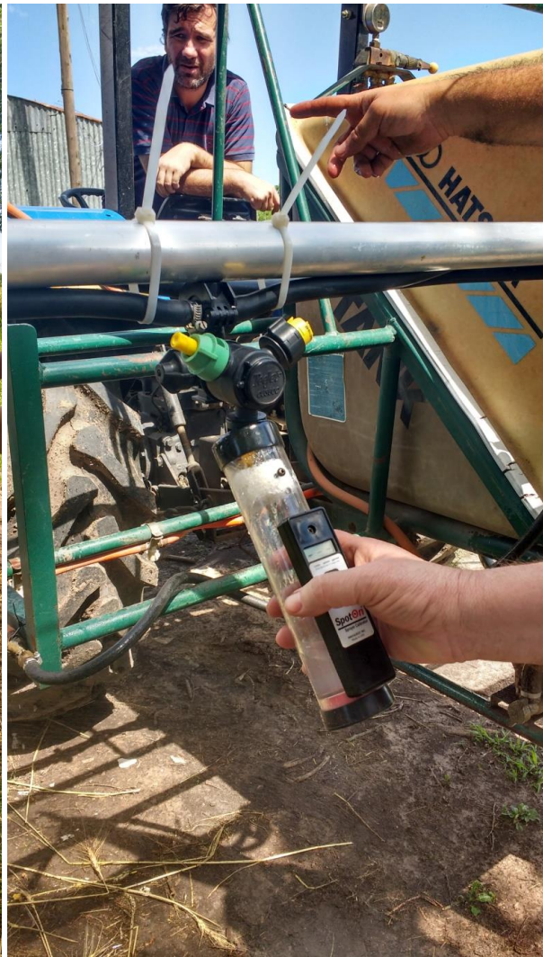
Foto 11. Control de caudal de las boquillas ( \text{l min}^{-1} ) mediante jarra graduada.
