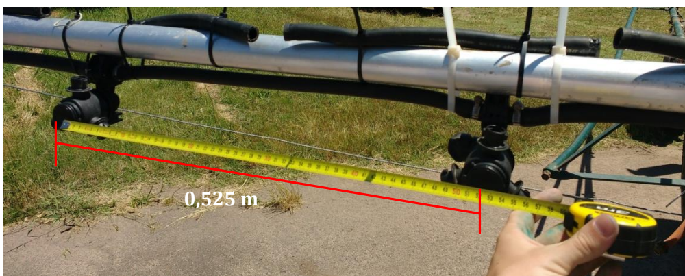
Foto 5. Distanciamiento entre boquillas de 0,525 m.
