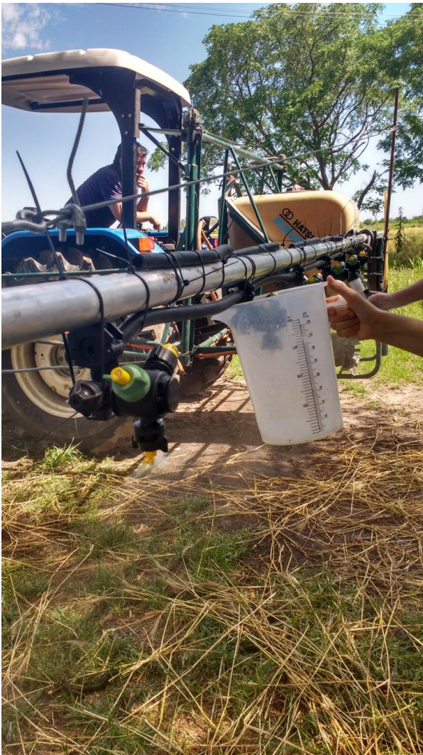
Foto 11. Control de caudal de las boquillas ( \text{l min}^{-1} ) mediante jarra graduada.
