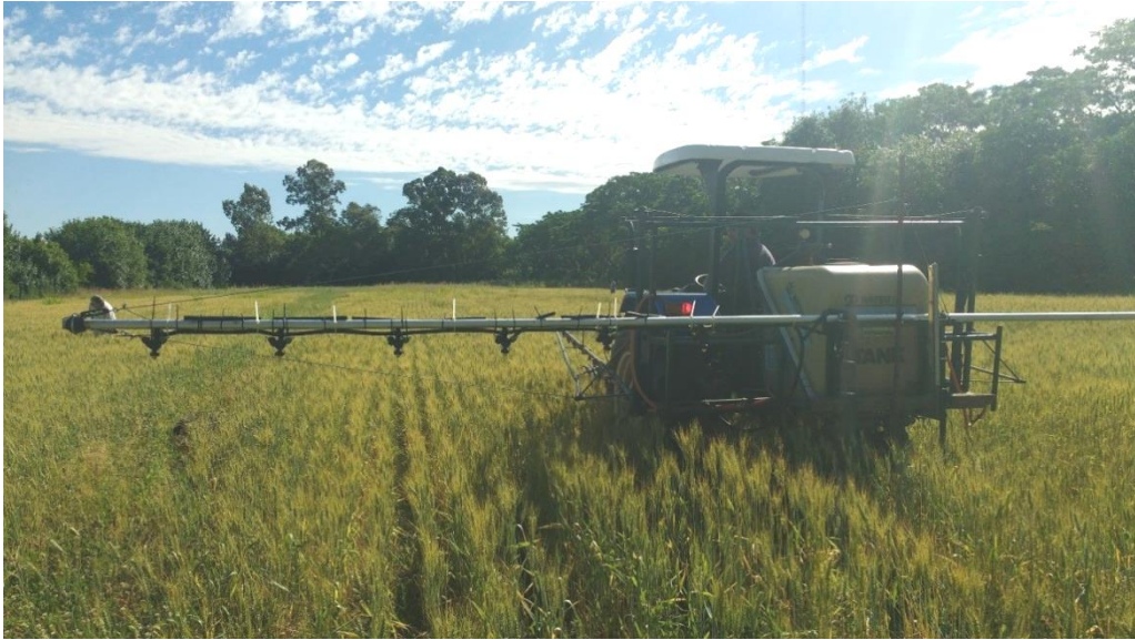
Foto 3. Equipo pulverizador hidráulico montado con un tanque de 400 l de capacidad, agitación hidráulica, bomba de pistón membrana accionada por la toma posterior de potencia.
