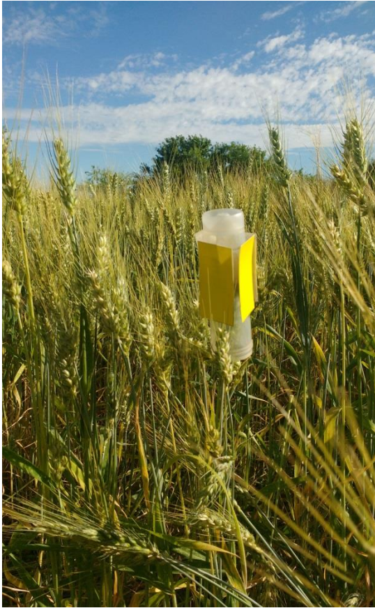
Foto 15. Tubo cilíndrico cubriendo la espiga con tarjetas hidrosensibles adosadas al mismo, previo al avance de la máquina pulverizadora. Las tarjetas fueron colocadas simulando las caras del objetivo vertical.
