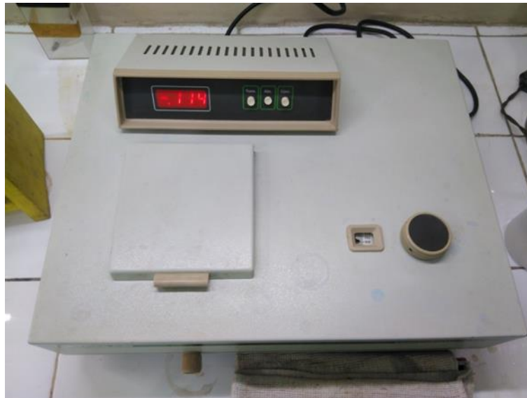
Foto 14. Espectrofotómetro de eje simple de UV-visible marca METROLAB, modelo 320.
