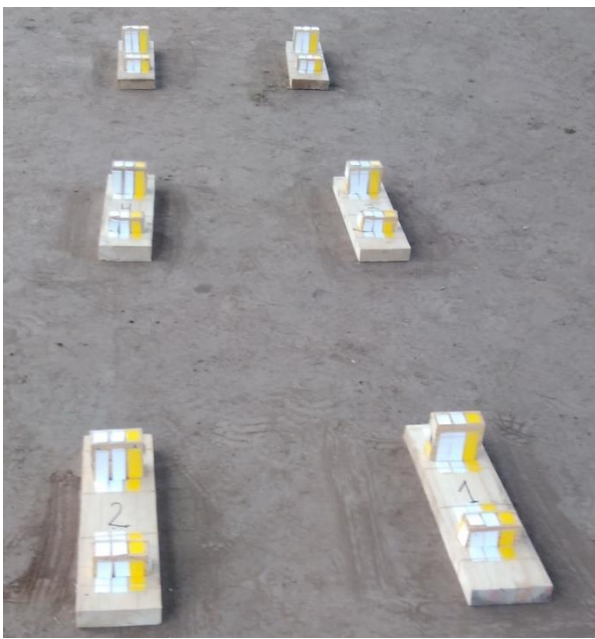
Foto 5: disposición de las tarjetas en los bancos de pulverización y disposición de los bancos sobre el suelo.
