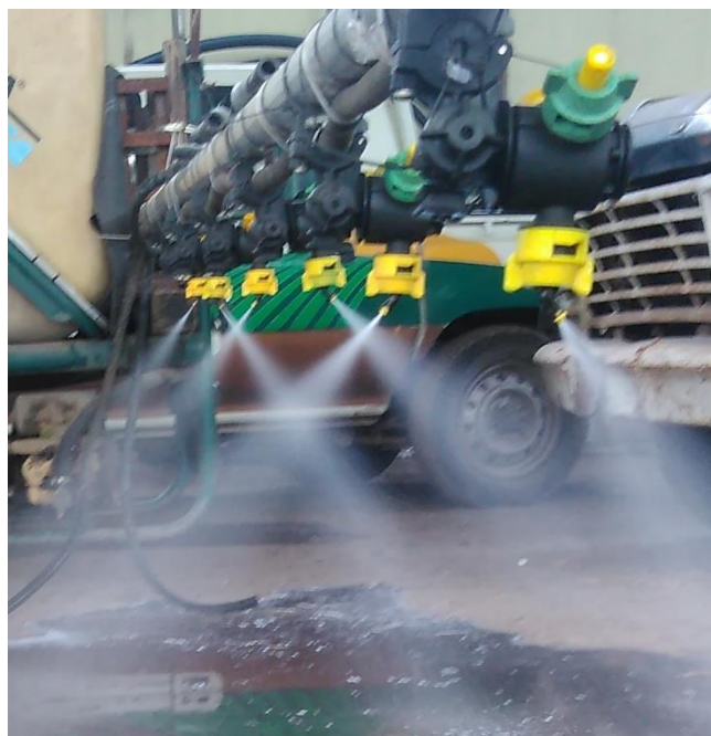
Foto 3: Disposición de las pastillas DD, intercaladas en el botalón hacia adelante y hacia atrás.
