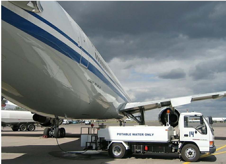
Figura 14 - Vehículo de abastecimiento de agua potable
