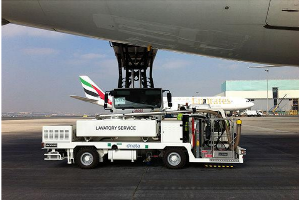
Figura 13 - Vehículo de limpieza de aguas residuales
