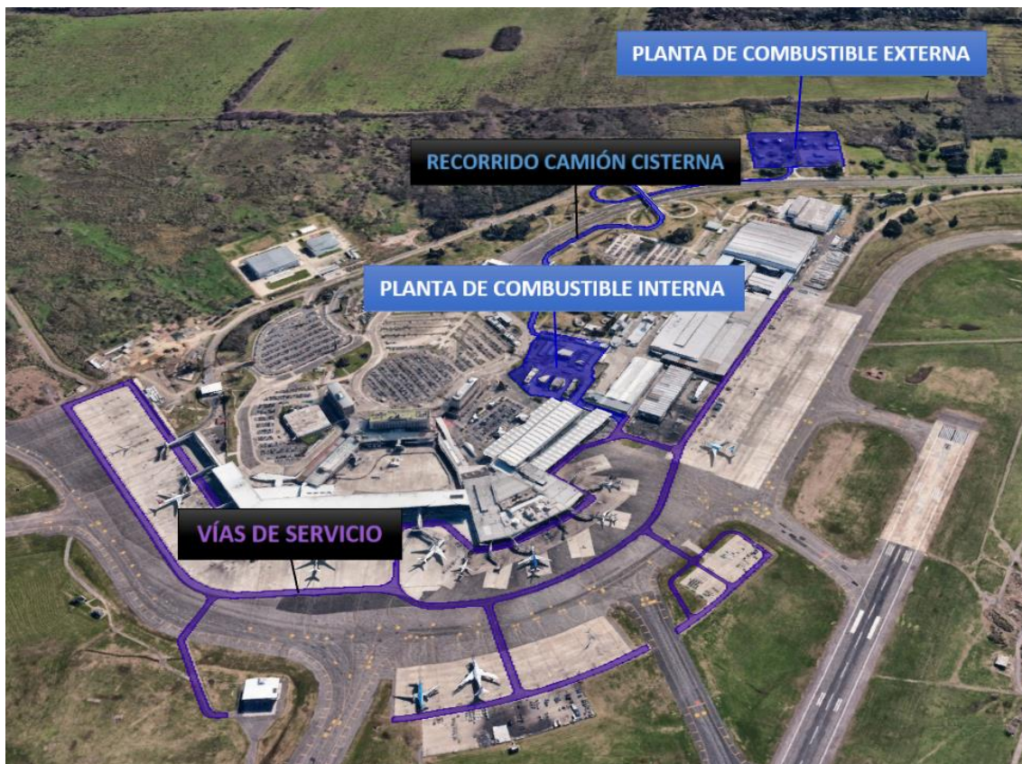
Figura 47 - Circuito de los camiones cisterna
