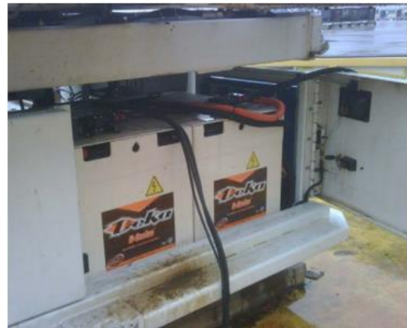
Figura 21 - Batería de plomo-ácido (izquierda) y compartimiento baterías del elevador de carga JBT Aerotech C15 (derecha) [6]
