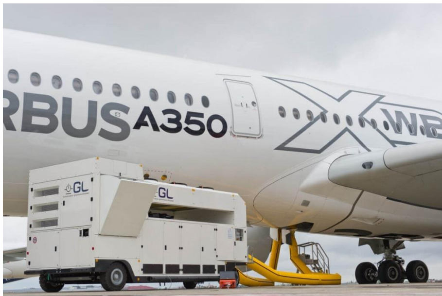
Figura 7 - Unidad de acondicionamiento de aire
