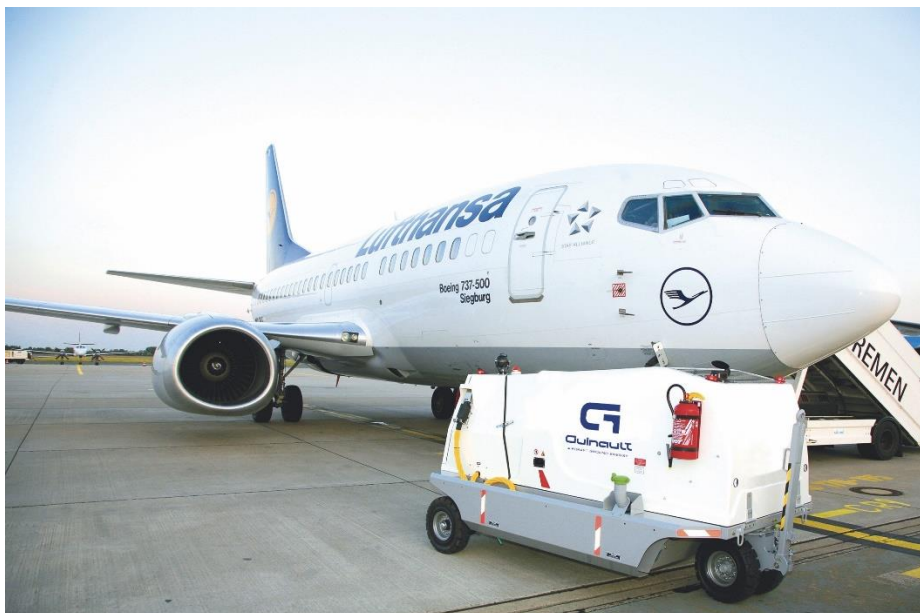
Figura 5 - Unidad de potencia en tierra (GPU)
